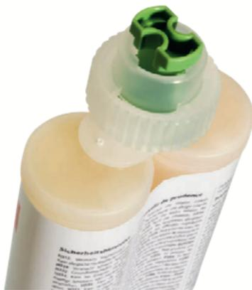
Avant d'ouvrir, insérez la cartouche dans le combiné : Assurez-vous que la cartouche est fixée dans la rainure de positionnement du combiné. Tournez le capuchon d'un quart de tour dans le sens antihoraire et retirez-le. Débranchez le bouchon vert et vérifiez que les deux ouvertures de la cartouche sont dégagées en appuyant légèrement sur la cartouche pour vérifier si les deux composants sont fluides.
